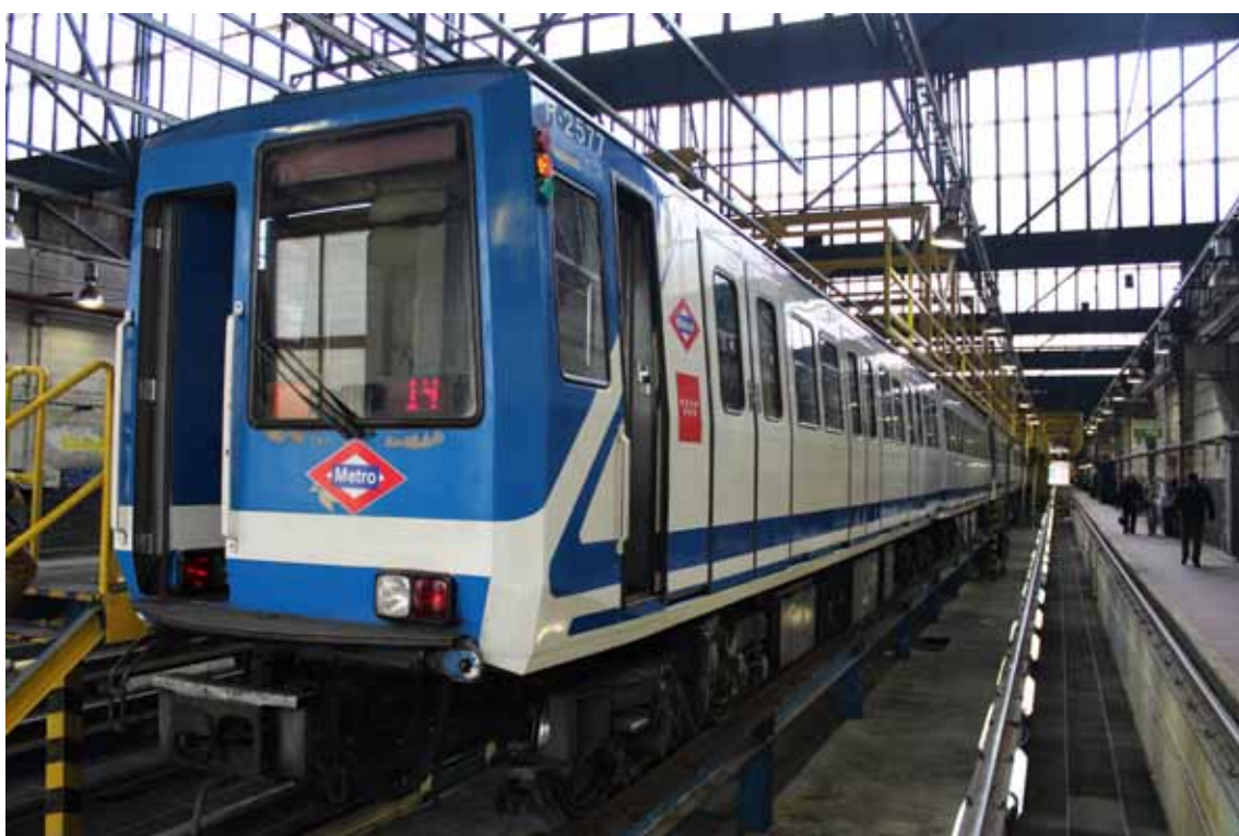
Fig.V.13-Interior de la 3ª y 4ª ampliación. La viga-lucernario original ha evolucionado a una banda de cristal continua. El coche tipo 2000 en primer plano es el último representante de las cuatro generaciones de material móvil de Metro que han pasado por estas cocheras. Antonio Manuel Sanz
