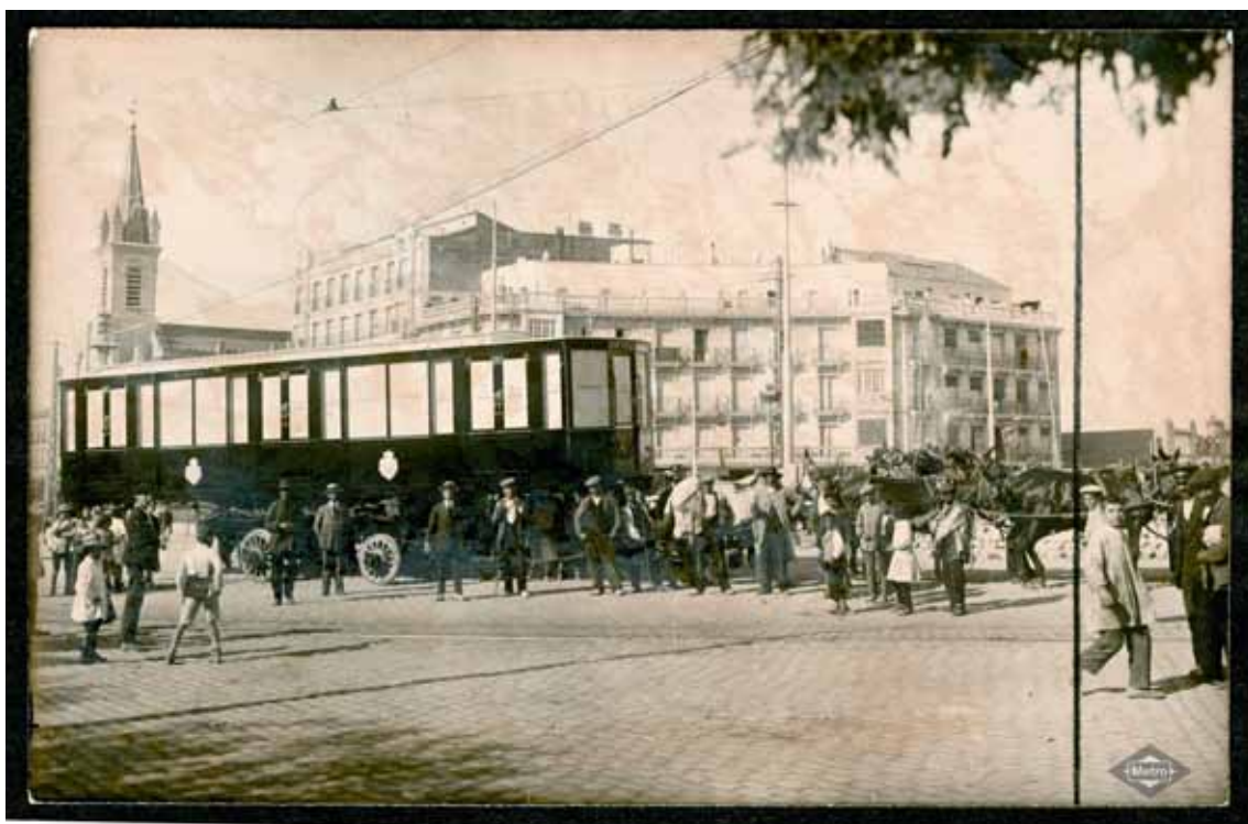
Fig.1.7- Llegada del primer vagón de Metro a Cuatro Caminos, 1919. Los coches fabricados por Carde y Escoriaza en Zaragoza se descargaron en la Estación de Atocha y desde allí se llevaron con tiro de sangre hasta las cocheras, donde se haría el ensamblaje final.
